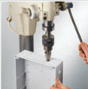
Кабельный ввод может быть просверлен индивидуально.
